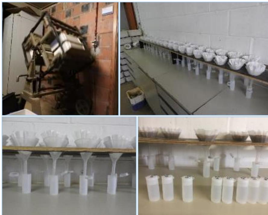
Figure 65 Extraction des nitrates des sols : en haut à gauche : la baratte utilisée pour agiter le mélange pendant 30 minutes ; à droite et en bas : filtration de la solution contenant les nitrates (source : DE SMIDT Marie-Aline, le 15 février 2019 à Corroy-le-Grand)
