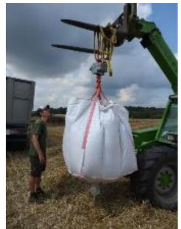
Figure 73 : Pesée du big-bag avec peson sur les fourches d'un télescopique (source : DE SMIDT Marie-Aline, le 2 août 2019 à Terwagne)
