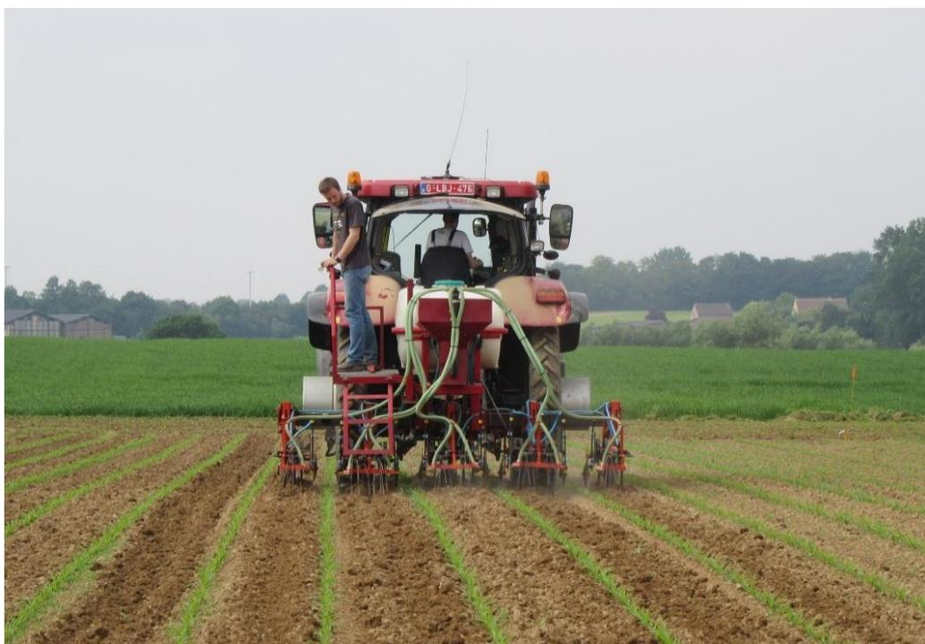
Figure 29 : Passage avec la désherbineuse (photo personnelle)
