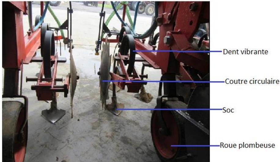
Figure 24 : Eléments de binage (photo personnelle)
