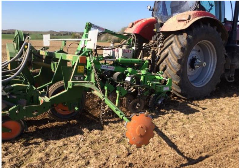
Figure 21 : Semis du maïs au strip-till (source : Regenacterre)
