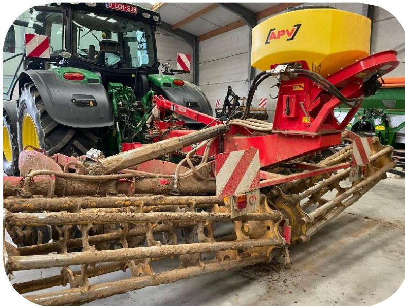
Figure 4 : Déchaumeur à disques avec semoir APV et éclateurs pour semis à la volée.
