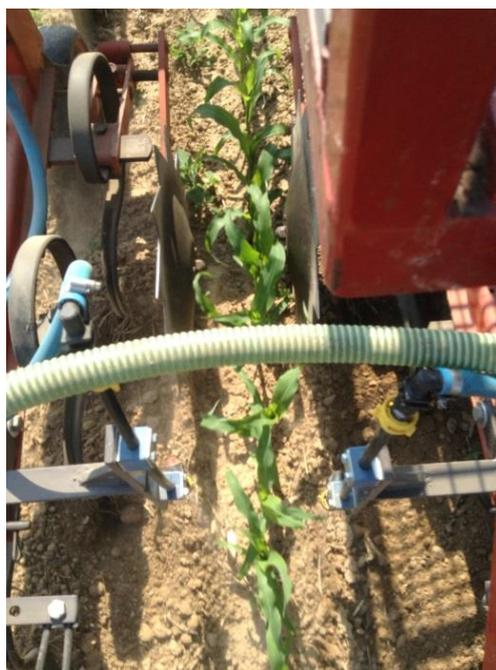
Figure 7 : Buses permettant de traiter le rang de chaque côté ainsi que les dents permettant de biner l'inter-rang
