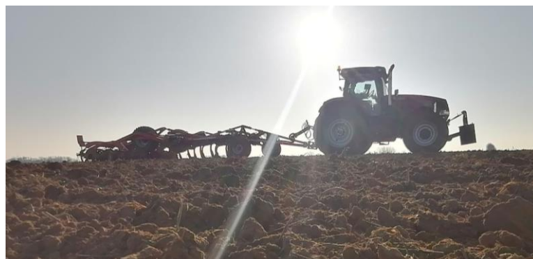
Figure 40. Cultivateur Horsch Terrano utilisé pour le travail du sol
