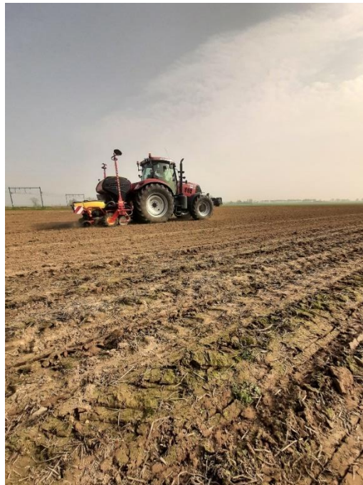
Figure 39. Semoir Vaderstadt Tempo utilisé pour le semis de la betterave
