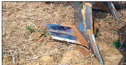
Les dents du décompacteur soulèvent et fissurent le sol, sans modifier les horizons
