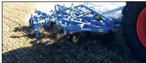
Le chisel lourd permet de travailler à une profondeur identique à celle de la charrue
