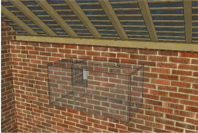
Figure 7. Exemple de nichoir pour effraie des clochers avec accès direct à l'extérieur, vu par transparence. Source : nichoirs.net
